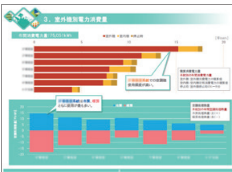
室外機別電力消費量
